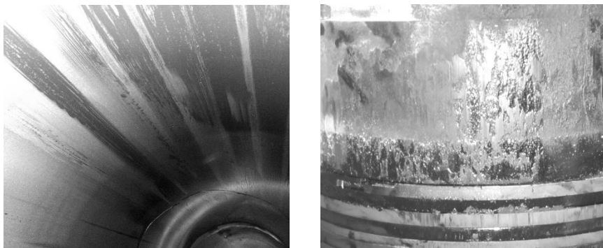
Рис.1. Характер натирань на дзеркалі ЦВ та утворення нагарів на поршні.
