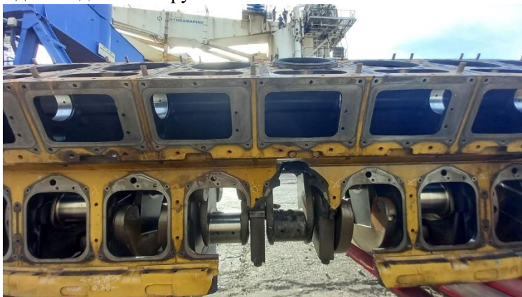
Рис.1 Аварійний випадок пов'язаний із поломкою ділянки колінчатого вала суднового двигуна.
