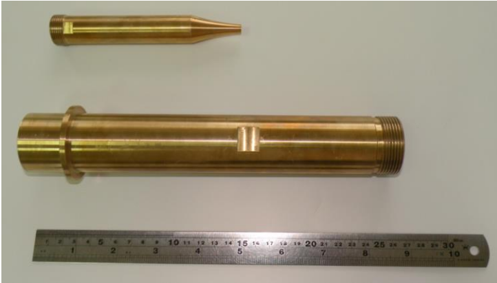
Рис. 6. Фотографія експериментального сопла і камери змішування
