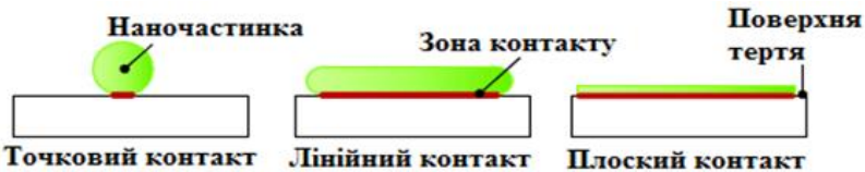
Рис. 3. Відображення впливу форми НЧ на їхню поведінку і властивості в зоні контакту поверхонь тертя під навантаженням [10]
