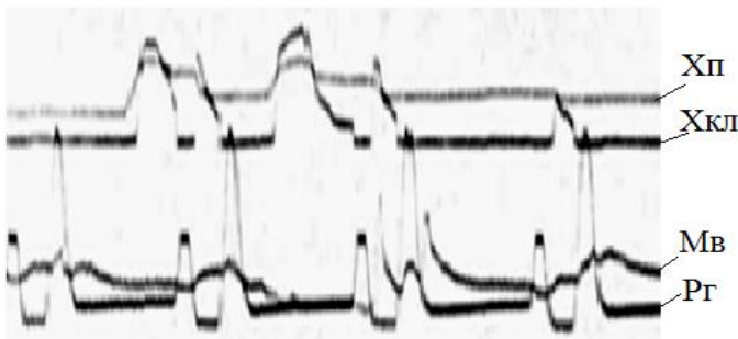
Рис.6. Осцилограма подачі мастила в циліндри ДВЗ синхронізованою системою
