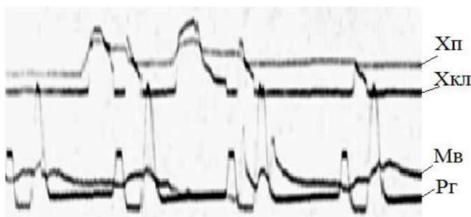
Рис.6. Осцилограма подачі мастила в циліндри ДВЗ синхронізованою системою
