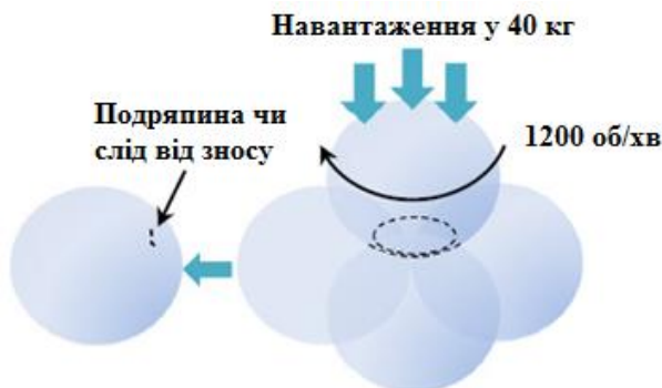
Рис. 3 – Трибологічна система з чотирьох кульок при використанні трибометра [20]
