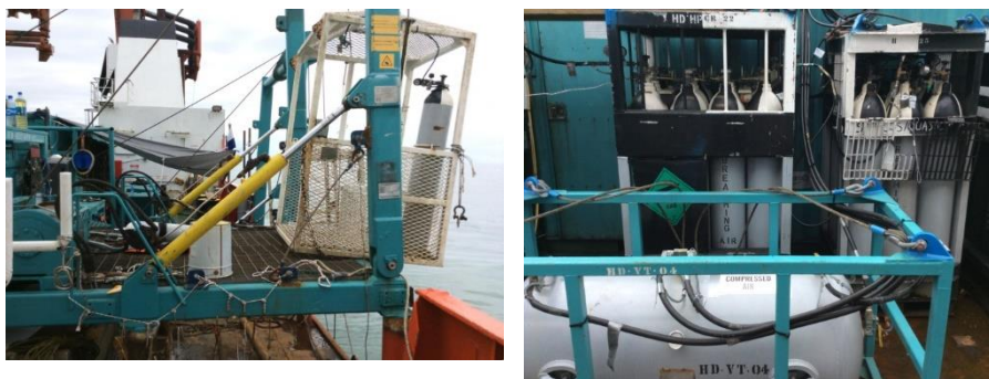
Рис. 4. Основні елементи водолазного обладнання а – піднімально-транспортна лебідка; б – компресорні балони
