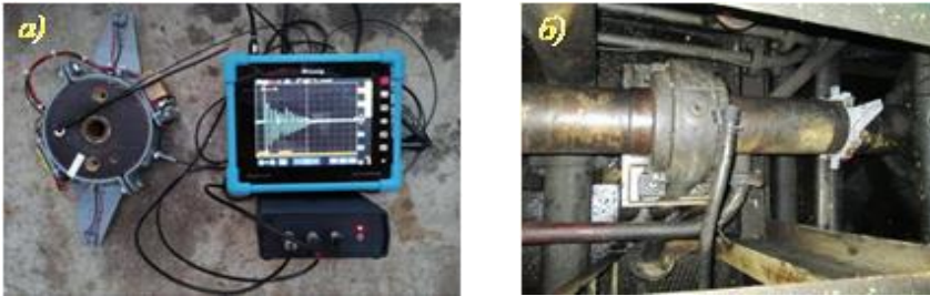
Рис. 3. Зовнішній вигляд: а) вимірювального пристрою; б) місця установки вимірювальної частини приладу на валопроводі.
