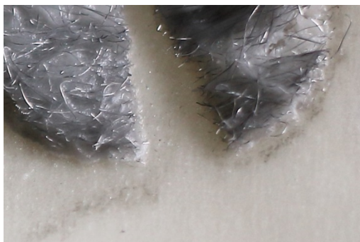
Рисунок 5 – Зображення сірих слідів на фільтрованому папері біля частково розплавленого зразка стеаринової кислоти зі вмістом алюмінієвого волокна через три місяця після створення зразків
