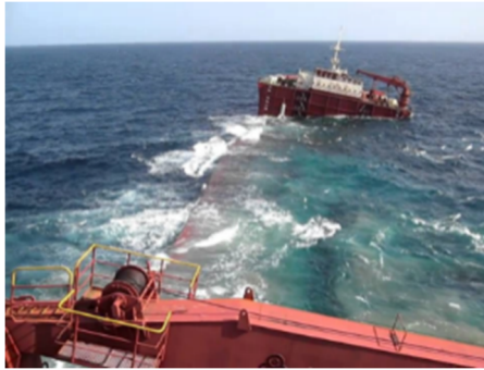
Рис. 5 Втрата остійності судном «MV Transporter»
