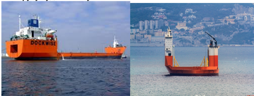
Рис. 1. Конструктивні виконання суден погрузного типу SEMI–SUBMERSIBLEHEAVY–LIFT
