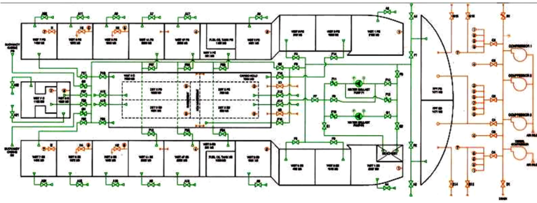
Рис. 4 Схема розташування компресорів на Heavy–Lift «Transshelf»
