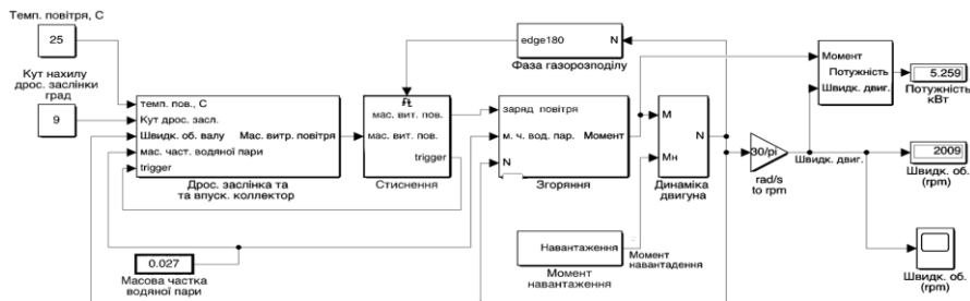
Рис. 4. Блок-схема адаптованої імітаційної моделі двигуна з урахуванням атмосферного тиску, вологості та температури повітря.
