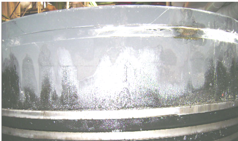
Рис.2 Сліди зустрічі масла з поверхнею головки поршня
