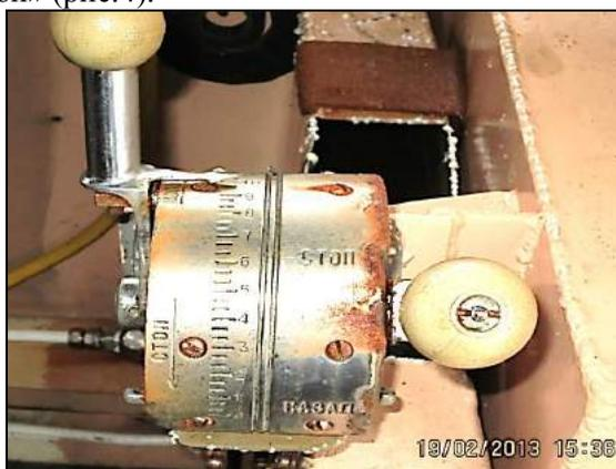
Рис.4. Положение ручек машинного телеграфа перед опрокидыванием буксира.
