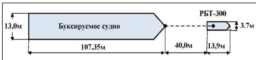
Рис.1. Схема буксирной системы.
