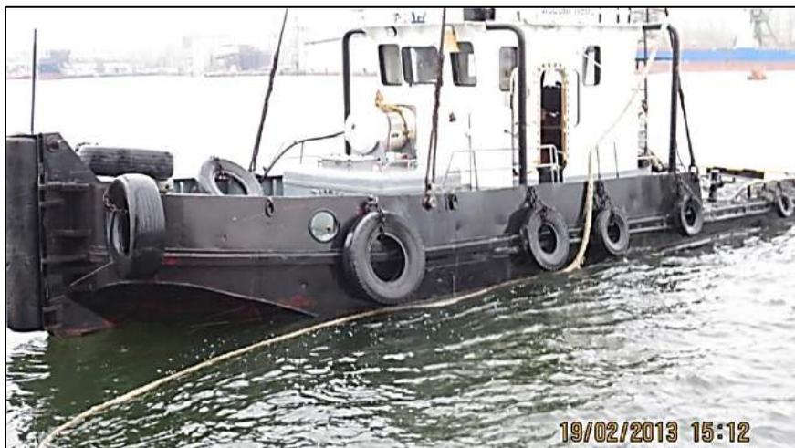
Рис.2. Общий вид буксира типа РБТ-300
