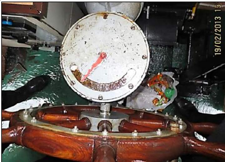
Рис.5. Положение руля зафиксировано на аксиометре - «лево на борт».
