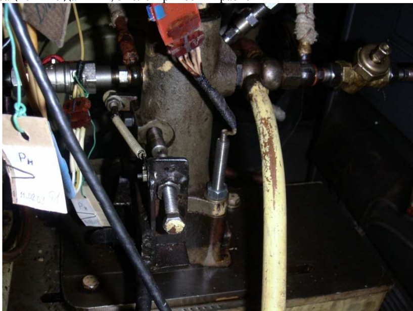
Рис. 4. Датчик давления топлива («Ш-Д») на ТНВД безмоторного стенда: 1 — датчик-шпилька, 2 — ТНВД
