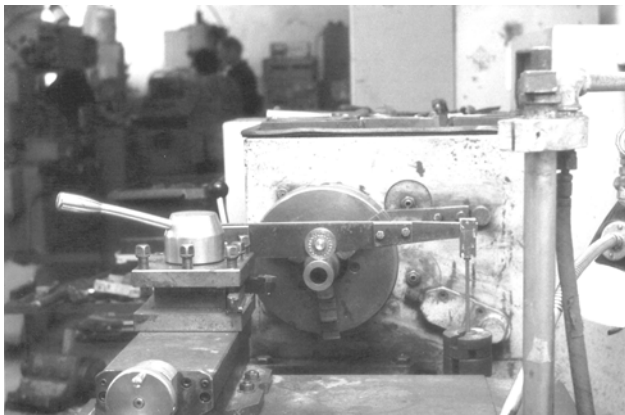
Рис. 4. Внешний вид приспособления для определения трибохарактеристик поверхностей плунжерной втулки дизеля
