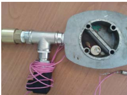
Рис. 7. Пьезокерамическая шайба, встроенная в крышку компрессора
