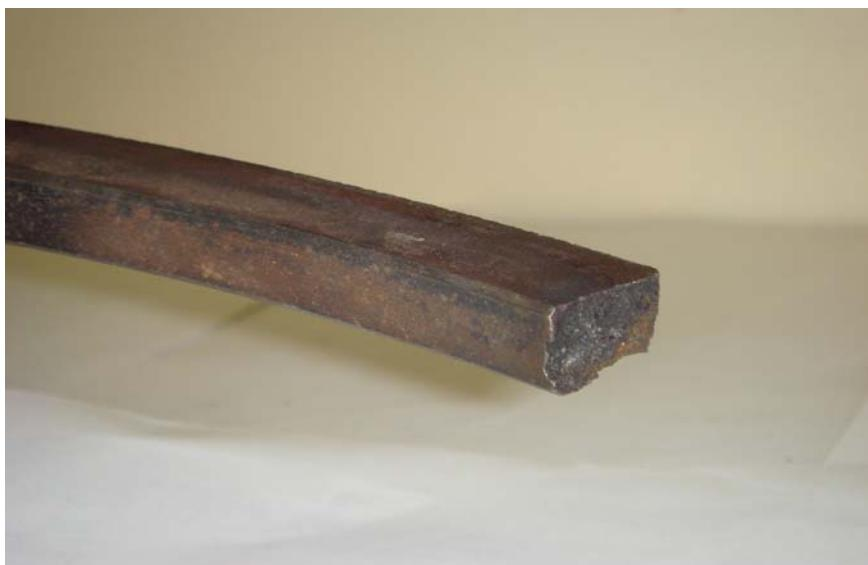
Рис. 4. Фрагмент поломанного уплотнительного кольца
