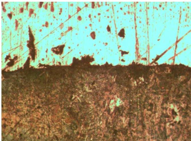
Рис. 11. Травленый микрошлиф. В верхней части сплав на основе меди, в нижней на основе железа,  $\times 450$
