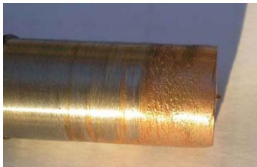
Рис. 6. Наплавленный вал после предварительной обработки
