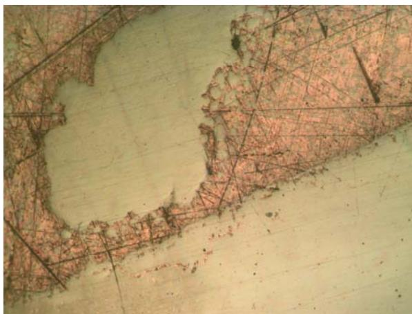
Рис. 8. Нетравленый микрошлиф. Механическая смесь железного и медного сплавов, возникающая при наплавке,  $\times 450$
