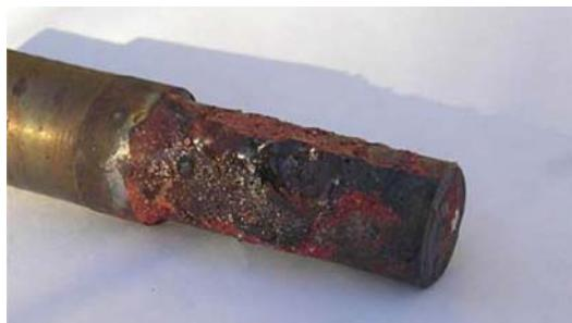
Рис. 5. Вал после наплавки
