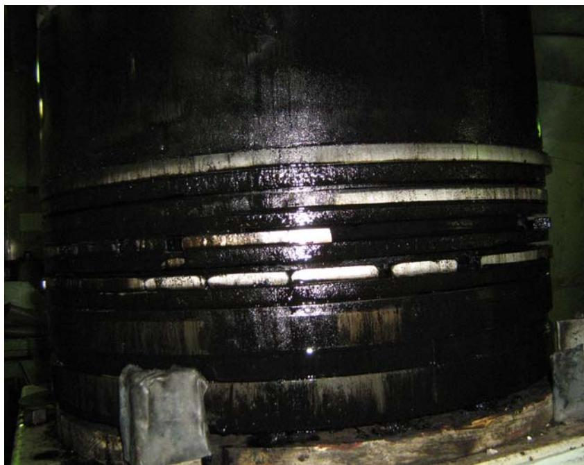
Рис. 3. Поршень двигателя SULZER 7RTA-62U с поломанными 3-м и 4-м кольцами
