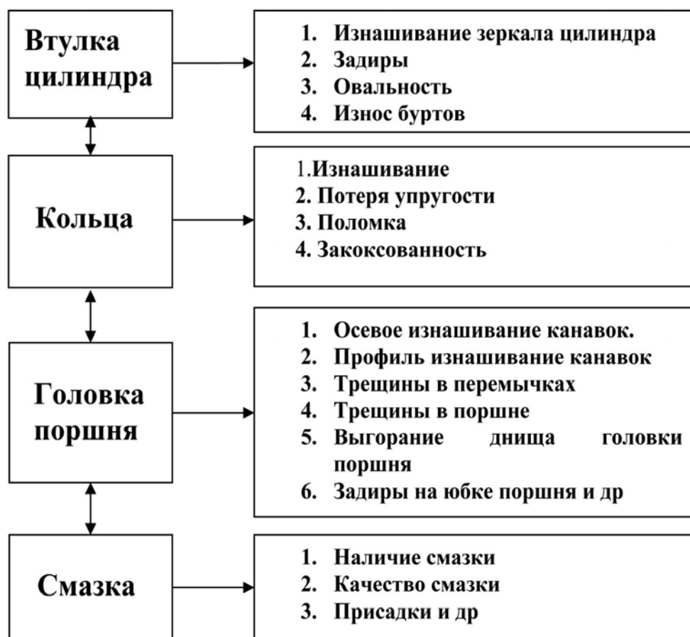
Рис. 2. Основные причины, вызывающие переход в неработоспособное состояние элементов ЦПГ
