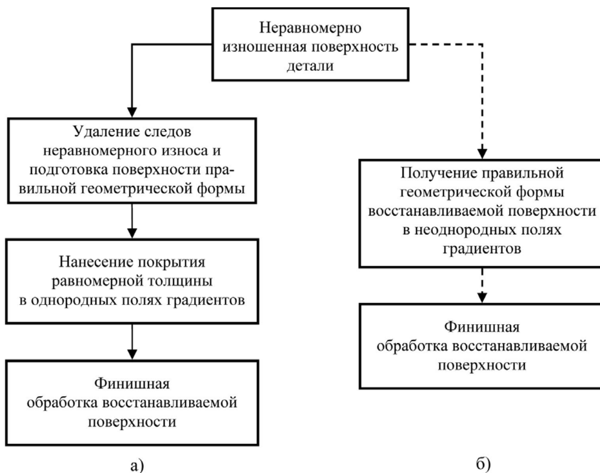
Рис. 1. Традиционная (а) и предлагаемая (б) укрупненные схемы восстановления изношенных поверхностей деталей ТС
