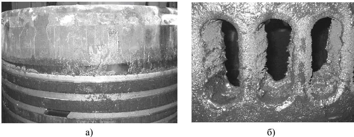
Рис. 1. Характерные нагарообразования на головках поршней (а) и в окнах (б)
