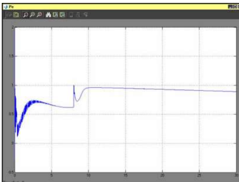
Рис. 5. Изменение мощности на генераторе при перегрузке
