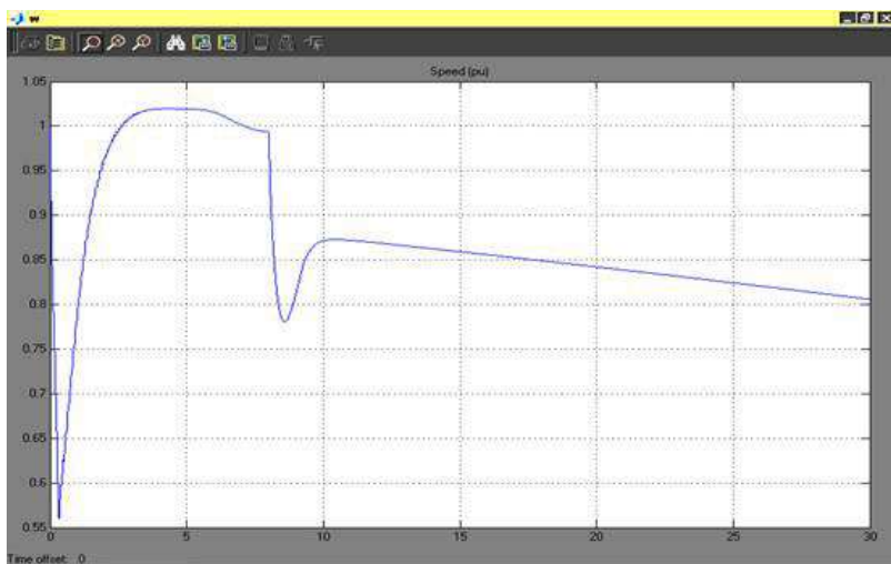
Рис. 2. Изменение частоты вращения ДГ при перегрузке 10%
