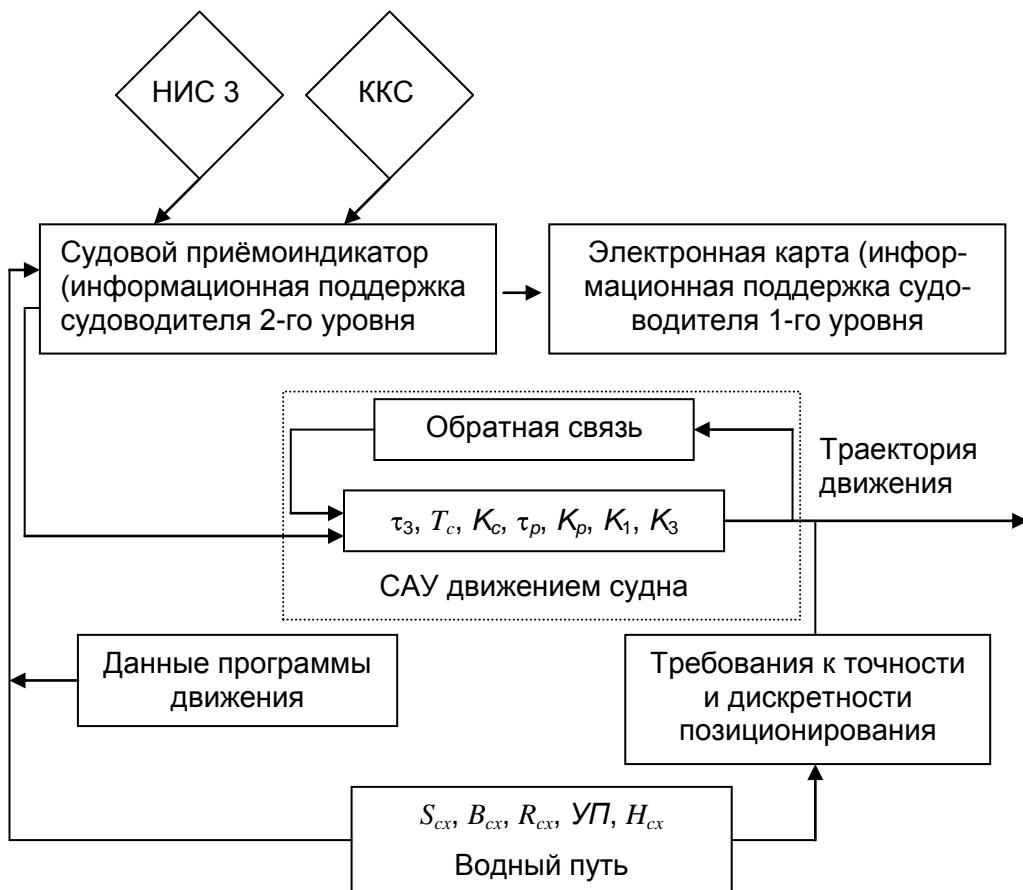
Рис. 4 Структурная схема логико-информационной модели управления движением судна
