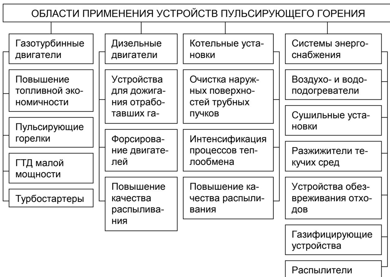
Рис. 1. Области возможного применения камер пульсирующего горения в стационарной и транспортной энергетике.
