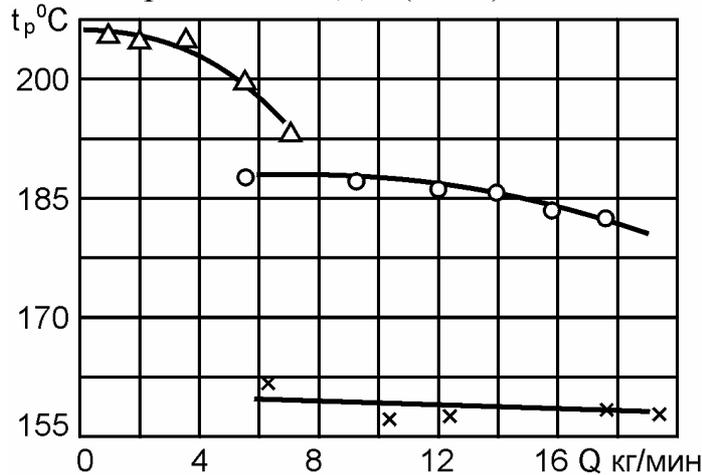
Рис. 5. Зависимость температуры распылителя от расхода охлаждающей жидкости.
